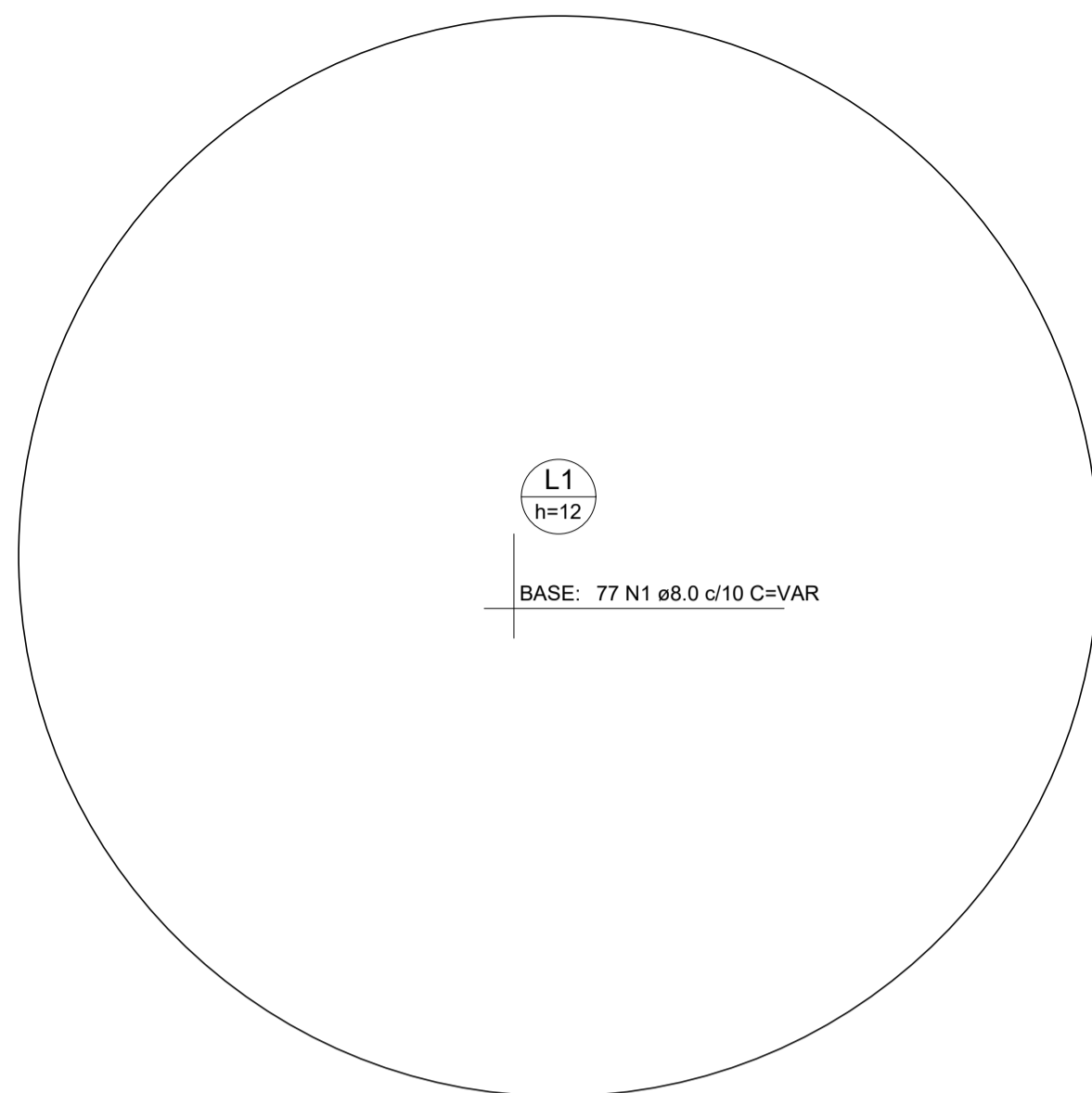
Armação superior da base do chafariz (Eixo X) escala 1:50
