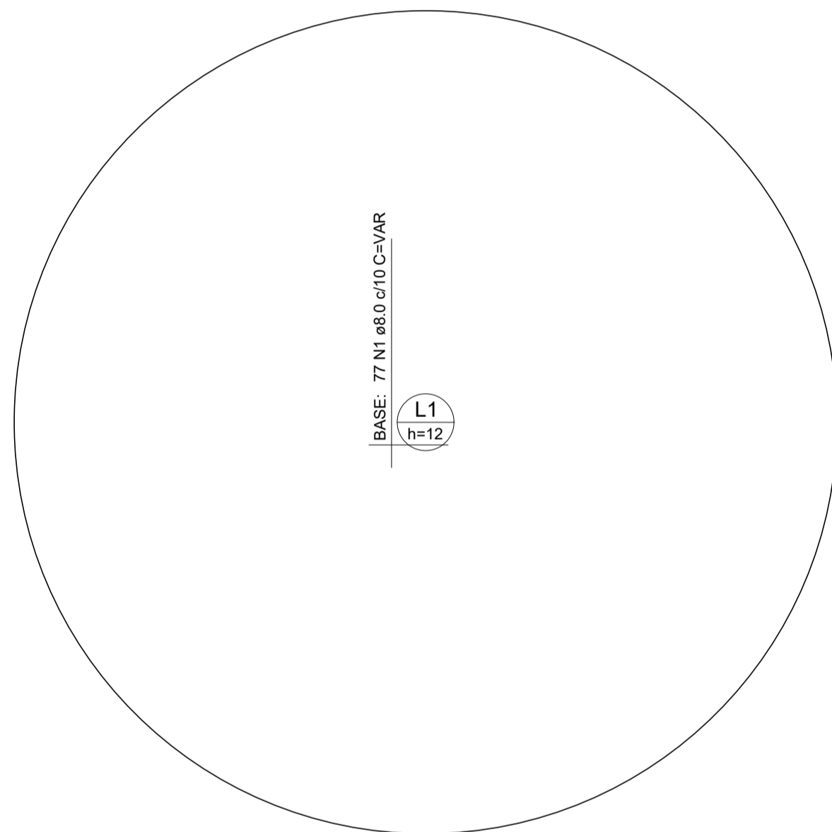
Armação superior da base do chafariz (Eixo Y) escala 1:50
